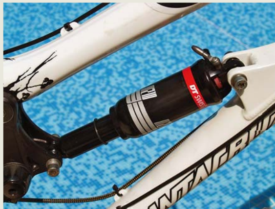
Staronový tlumič M210 využívá technologie z oblíbeného modelu SSD 210L
